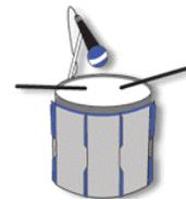
Um das zu vermeiden, sollten Sie die Mikrofonposition variieren, bis Sie den gewünschten Sound "erwischt" haben. Jedenfalls sollte das Mikrofon in einem Abstand von ca. vier bis zehn Zentimeter und in einem Winkel von etwa 45 Grad auf den Schlagfell-Rand ausgerichtet werden.
